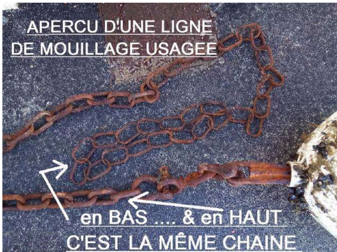
L'usure inégale d'une ligne de mouillage limée par le frottement sur le sable
