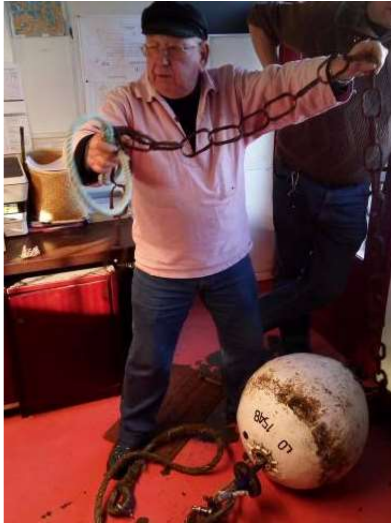
L'usure inégale d'une ligne de mouillage limée par le frottement sur le sable
